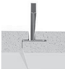
D1- en D2-aansluiting t.p.v. tussenprofiel
