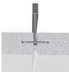
C-aansluiting t.p.v. hoofdprofiel
