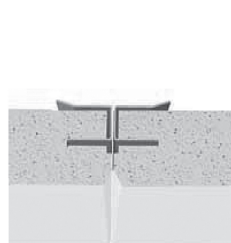
C-aansluiting t.p.v. klemprofiel
